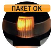
Индикация результата затяжки непосредственно на инструменте
