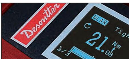
Благодаря простому двухстороннему протоколу обмена данными, беспроводная сеть DeltaWrench Wlan (клиент TCP) может легко настраиваться через приложение заказчика (сервер TCP).
