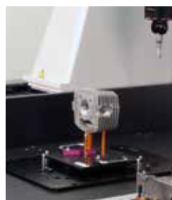
K551218: Применение системы приемника паллет
