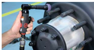
1 – Чистка барабана (Угловая зачистная машинка, стр. 42)
