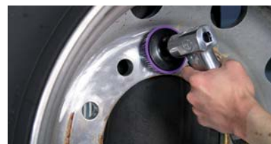
3 – Чистка колес (Полировальная машинка, стр. 52)
