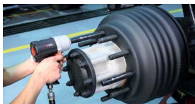
2 – Установка втулок в барабан (Ударный гайковерт, стр. 16)
